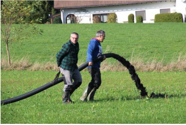
Der Saugkorb muss ständig gereinigt werden
